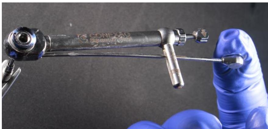
**Figura 14 Torque en la interfase implante pilar**
