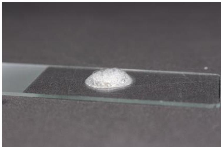
**Figura 6 Peróxido de hidrogeno, observando desprendimiento de burbujas de gas**
